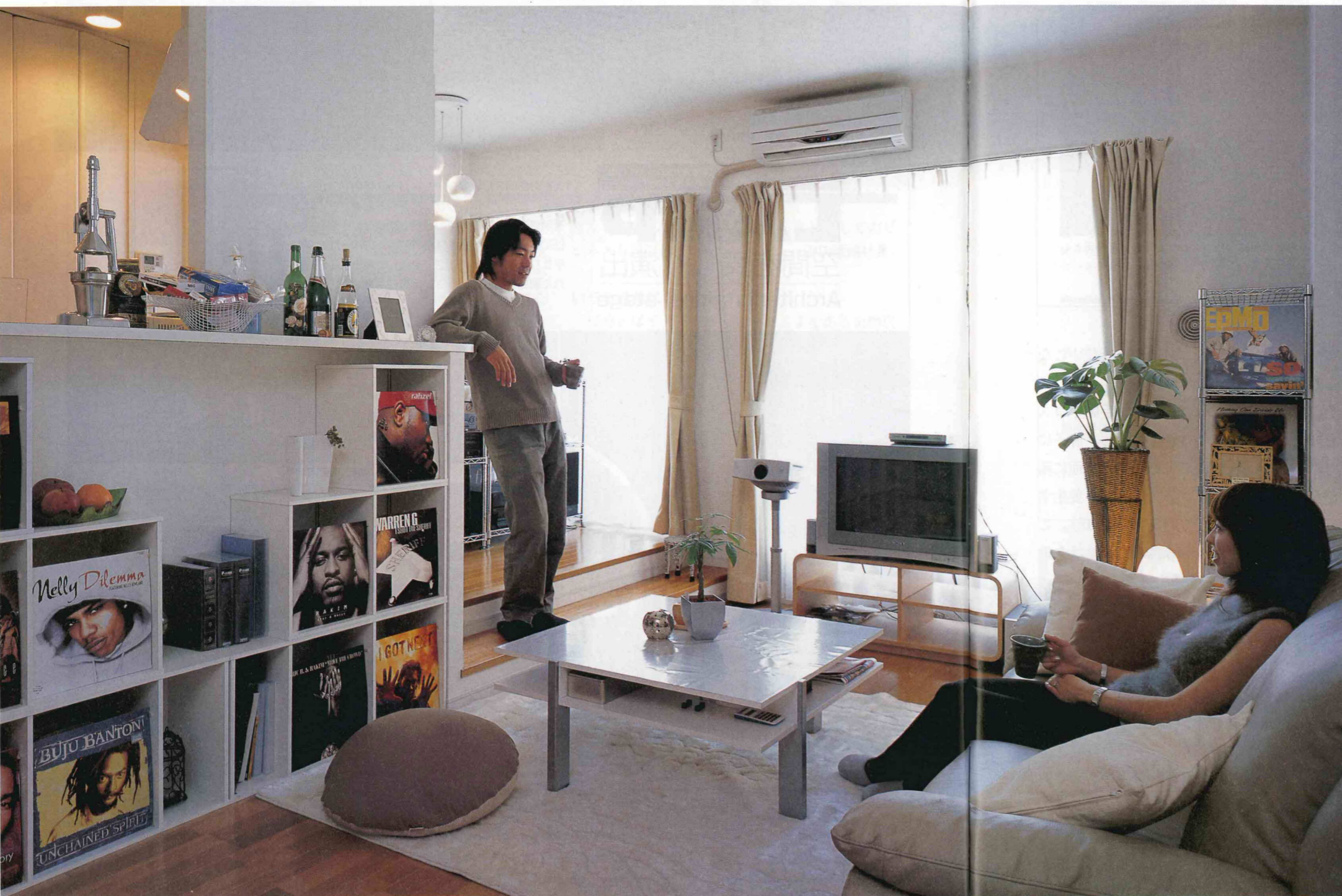
ヴィラカテリーナの一角。左側の棚の向こう側に廊下を兼ねたキッチンになっている。このほか、このタイプの居室にはパウダールームと寝室がある。床スラブを下げ、ダクト類を壁に寄せるなどして約2.7mの天井高を確保した。エアコンの位置で、その高さがわかる（写真：目黒伸宣）
