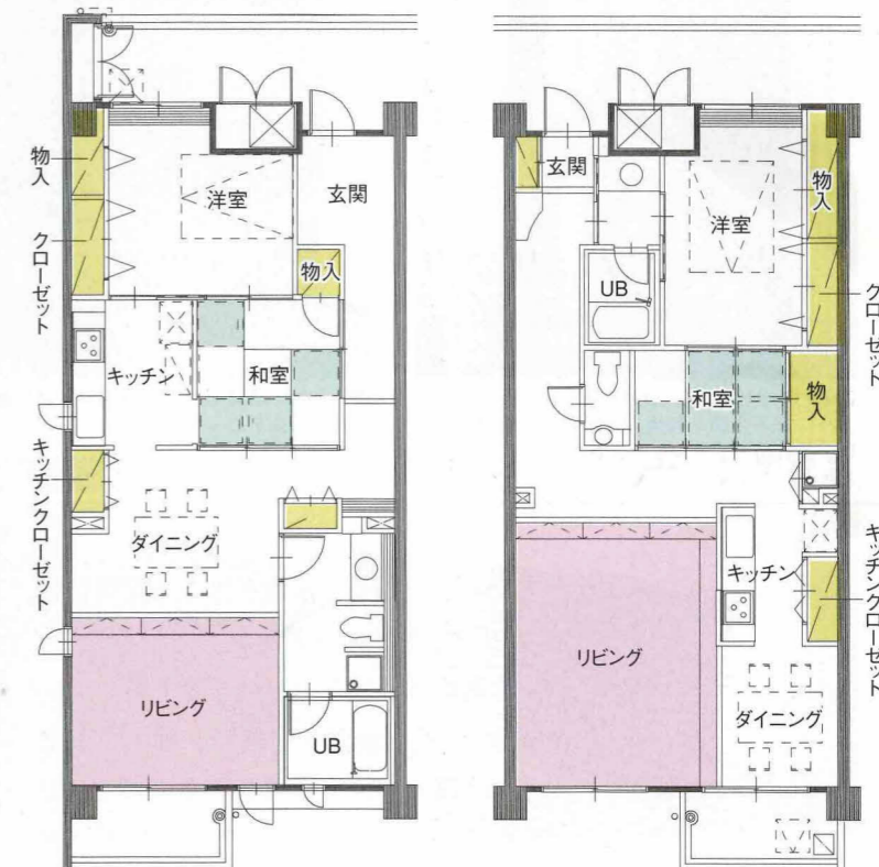
Cタイプ平面図 (1/150) 床下収納 1段上がった和室の床下収納 天井の高い空間
